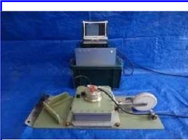
防水型装置(樋門底盤裏空洞探査用)
