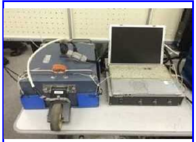
陸上型装置(樋門側壁・頂版裏空洞探査用)
