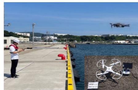
写真3 ドローンによる施設点検 (岸壁の状況をカメラで確認の様子)
