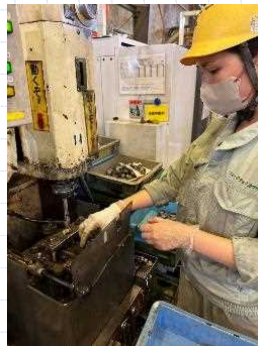
熱処理後の研磨加工でも通り・止まりのゲージを使用し簡易な確認をしている。(全数) 研磨加工では寸法公差0.001mmの管理が必要。
