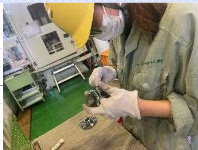
ネジ加工後の確認もゲージを使用し品質確認をする。
