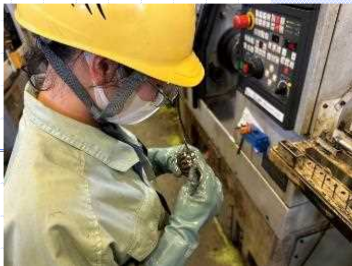
外径寸法確認方法として、ハサミゲージを使用する。
