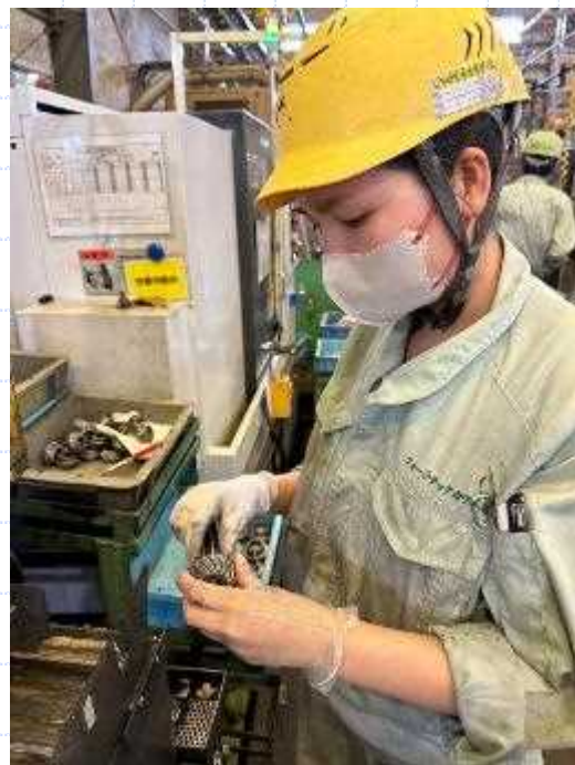
熱処理後の研磨加工でも通り・止まりのゲージを使用し簡易な確認をしている。(全数) 研磨加工では寸法公差0.001mmの管理が必要。
