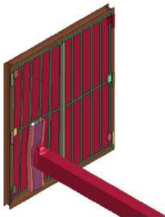
図 5.2-11 防護扉（扉表面）の変形挙動（最終時刻）
