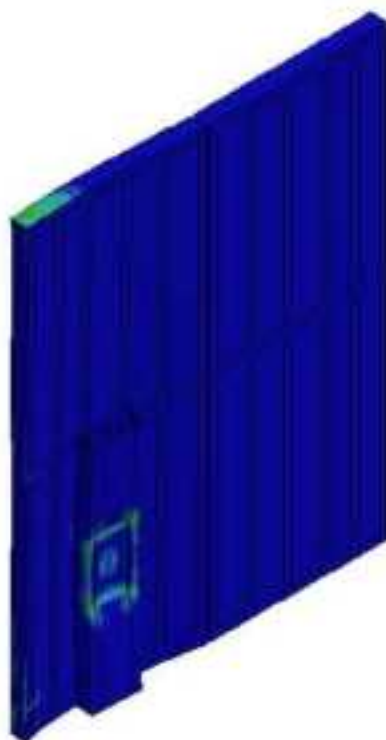
図 5.2-9 防護扉（扉表面）のひずみ分布（最終時刻）
