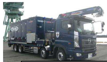
可搬型代替注水大型ポンプ(放水用)
