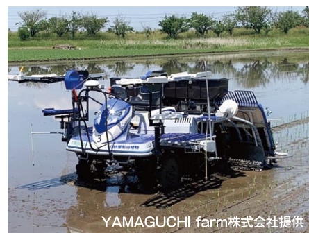
▲ロボット技術やICTを活用したスマート農業 (自動運転田植機による田植え作業)
