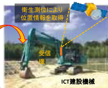
3次元設計データを建設機械に搭載
