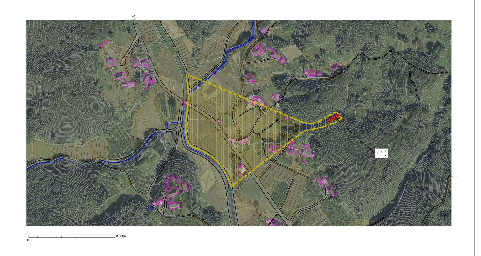
様式-2(土) 土砂災害防止法施行令第二条の基準に該当する区域 土石流 渓流番号 | 364-Ⅱ-133 土石流の高さが1m超える場合、土石等の 移動による力が50kN/mを超える区域 土砂災害警戒区域・土砂災害特別警戒区域 渓流名 告示番号 茨城県告示第153号 無名沢27 土石流の高さが1m超える場合、土石等の 移動による力が50kN/㎡以下の区域 区域図(その1) 縮尺 1:2,500 告示年月日 平成27年2月19日 所在地 茨城県久慈郡大子町浅川
