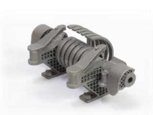
造形物：人工衛星のソーラーパネル展開用ヒンジ(一体成型により軽量化と耐久性を向上)
