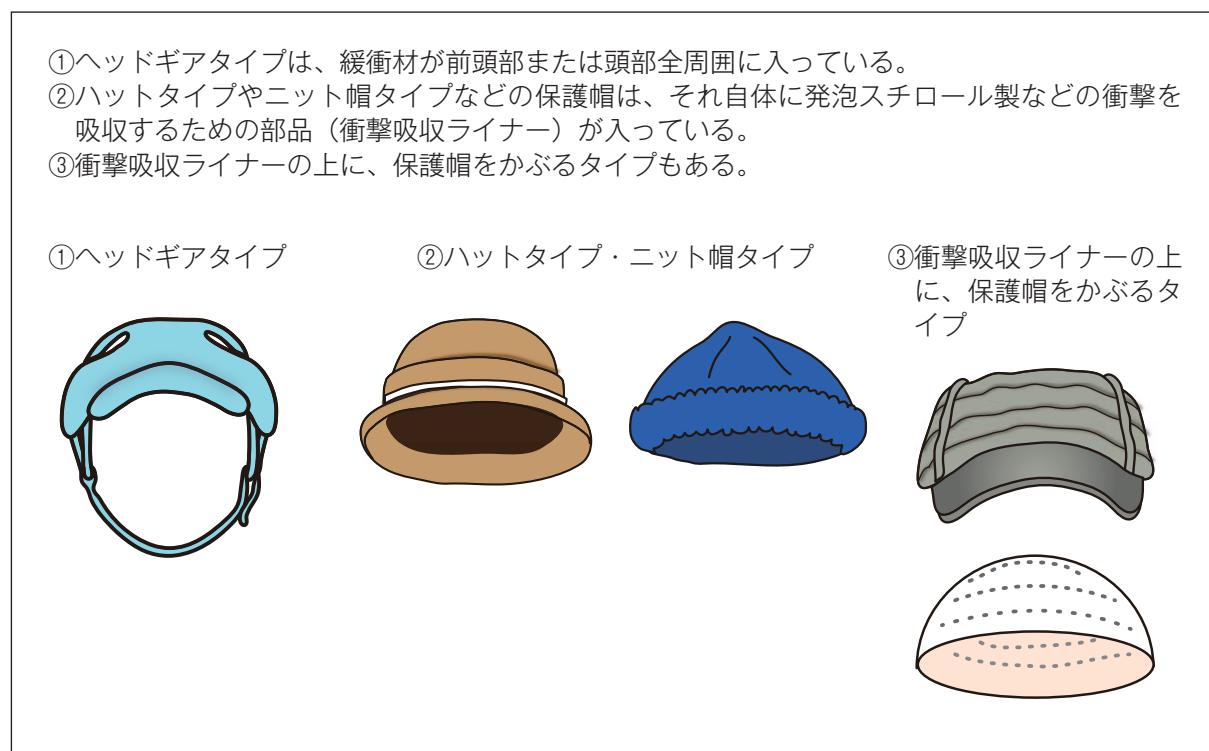
図4 保護帽のタイプと構造
