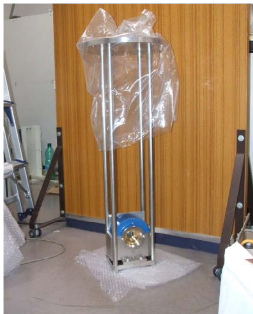
図 1 作製した i-MATERIA 用磁場印加ホルダ。青色部分は円環磁石
