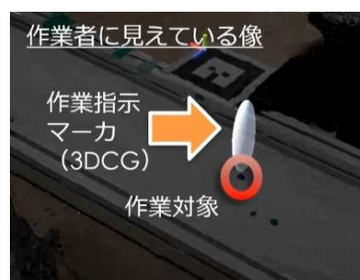
図2 スマートグラスを用いた作業指示例
