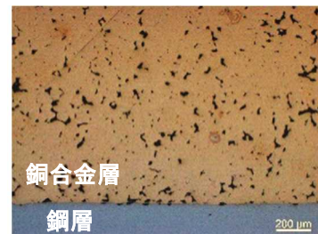
図2 クラッド材の断面拡大観察
