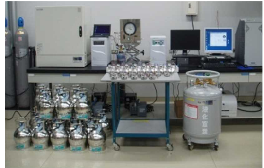
図1 キャニスター濃縮装置付 ガスクロマトグラフ質量分析装置
