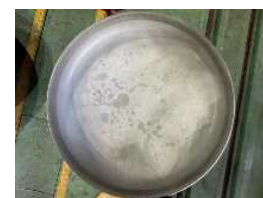
図4 実験で製作した鏡板
