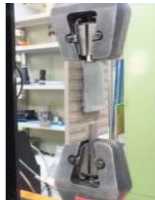
図 2 支持金具の強度試験
