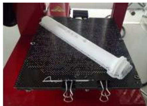
図2 グリップ試作造形の様子
