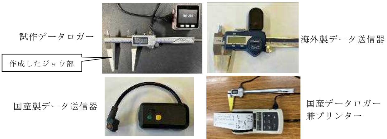
図1 各種ノギスデータ送信・記録機器
