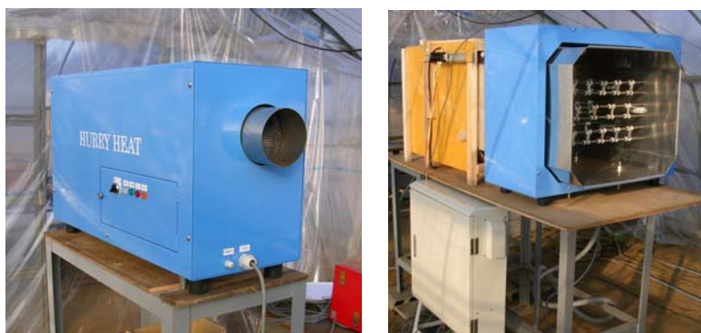
図1 供試した電気式温風機 (MGFAN25 : 左と試作機 : 右)
