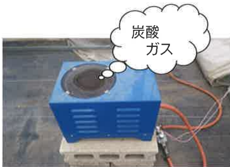
図1 燃烧式の炭酸ガス発生装置
