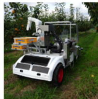
ニホンナシ収穫・ 運搬ロボット (農研機構)
