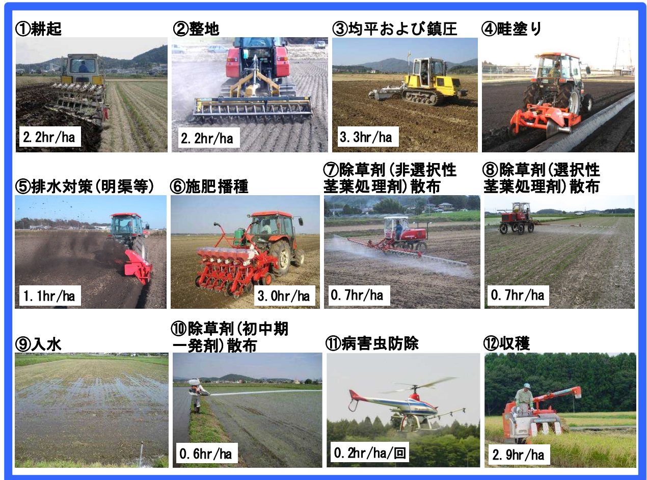
図4. 水稲の不耕起乾田直播栽培の作業体系および圃場作業時間
