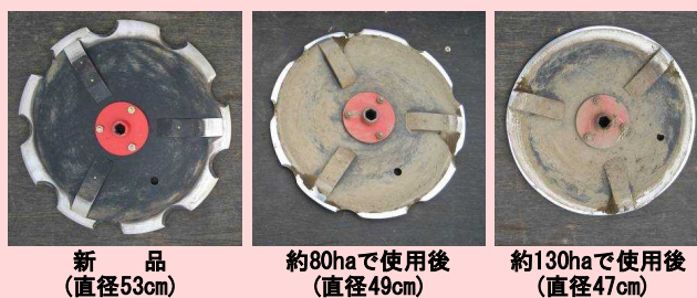
図38. 作溝ディスクの磨耗
