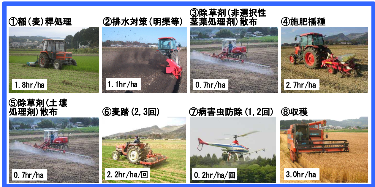
図30. 麦類の不耕起播種栽培の作業体系および圃場作業時間
