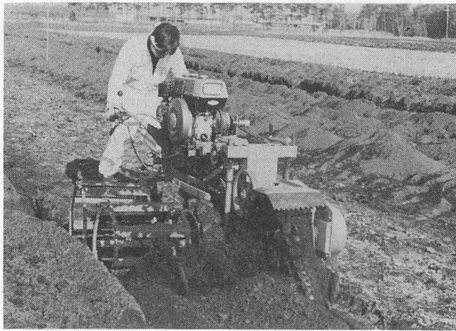
生育畦の側方10cm前後の所を後進しながら70cm前後の深さに掘削する。
