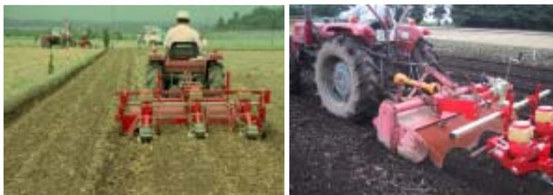
図1 試作した平高畝播種機(左)および高畝播種機(右)
