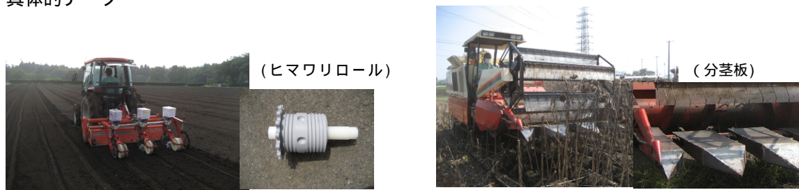
図1.ロータリーシーダーによる播種作業(左)と汎用コンバインによる収穫作業(右)
