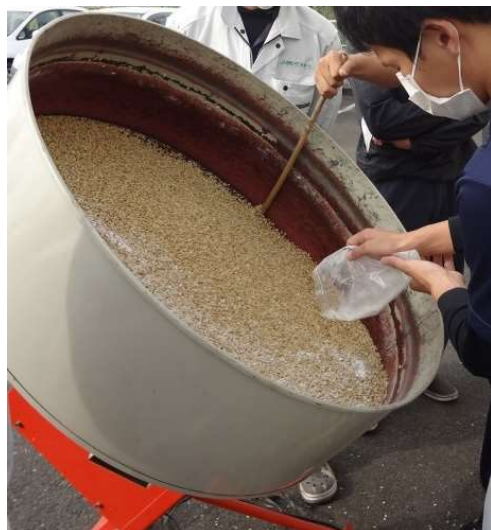
図1 既存のコーティング機を利用した湿粉衣処理
