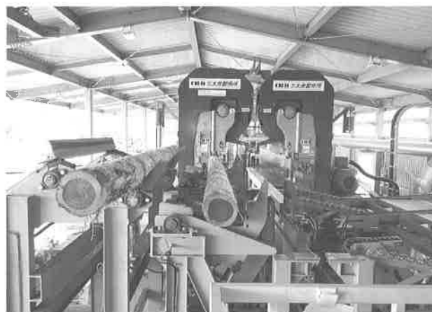
写真-1 製材工場に導入したツイン帯鋸盤
