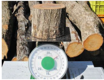
写真-5 原木重量の計測
