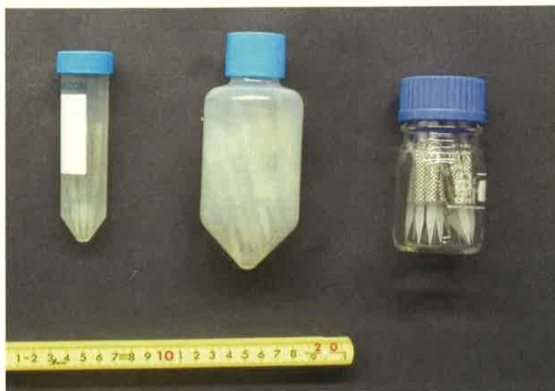
写真-1. 接種資材の培養用容器 左より、50mL ファルコンチューブ、200mL ファルコンチューブ、100mL デュラン瓶。
