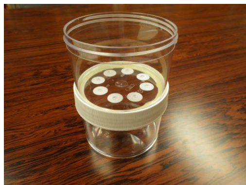
写真-2. 横方向コンパートメント容器
