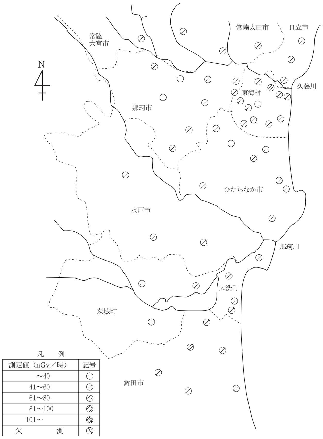
図1 原電又は原子力機構大洗から10km圏内の一般環境における空間 $\gamma$ 線量率測定結果(3か月平均値)
