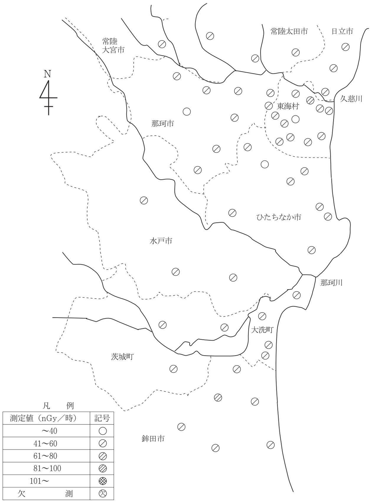
図1 原電又は原子力機構大洗から10km圏内の一般環境における空間γ線量率測定結果(3か月平均値)
