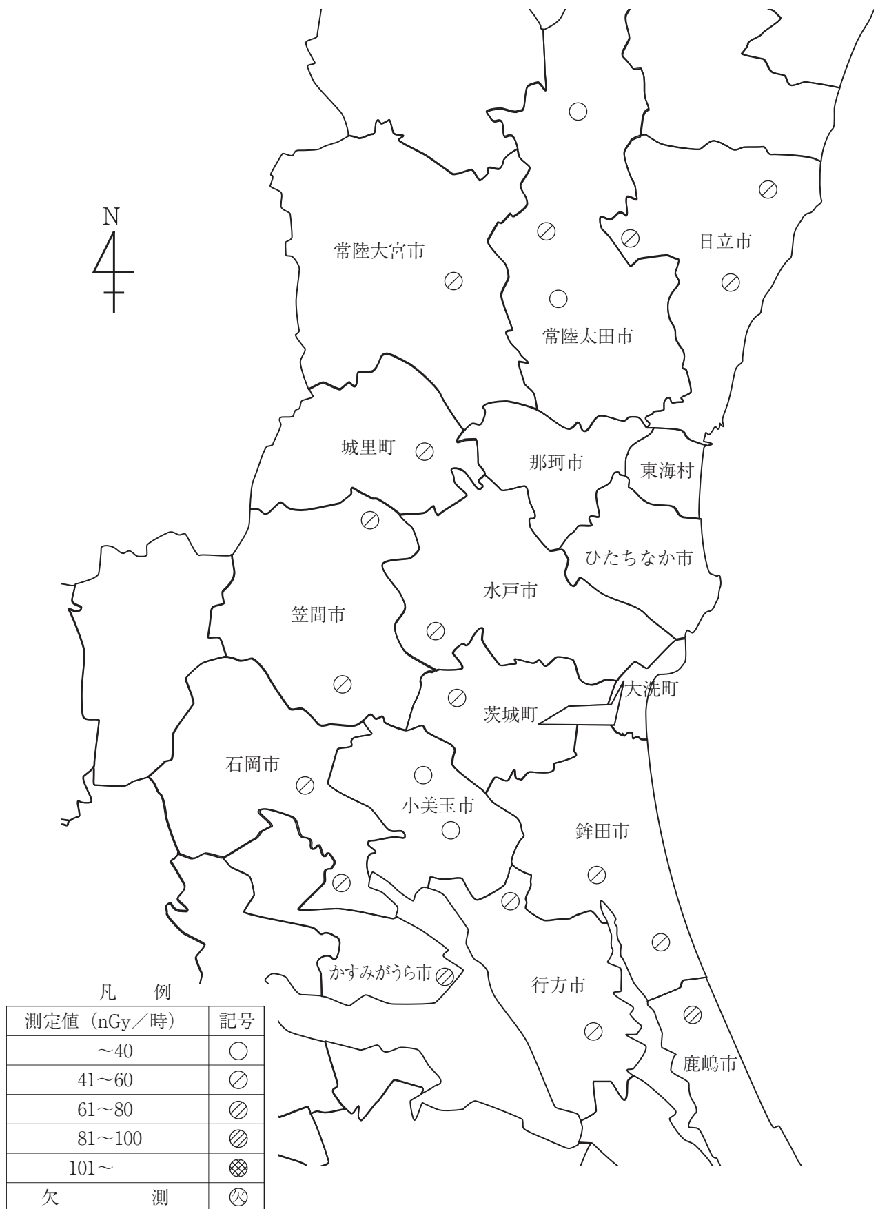
図2 原電又は原子力機構から10~30km圏内地区における空間γ線量率測定結果(3ヶ月平均値)
