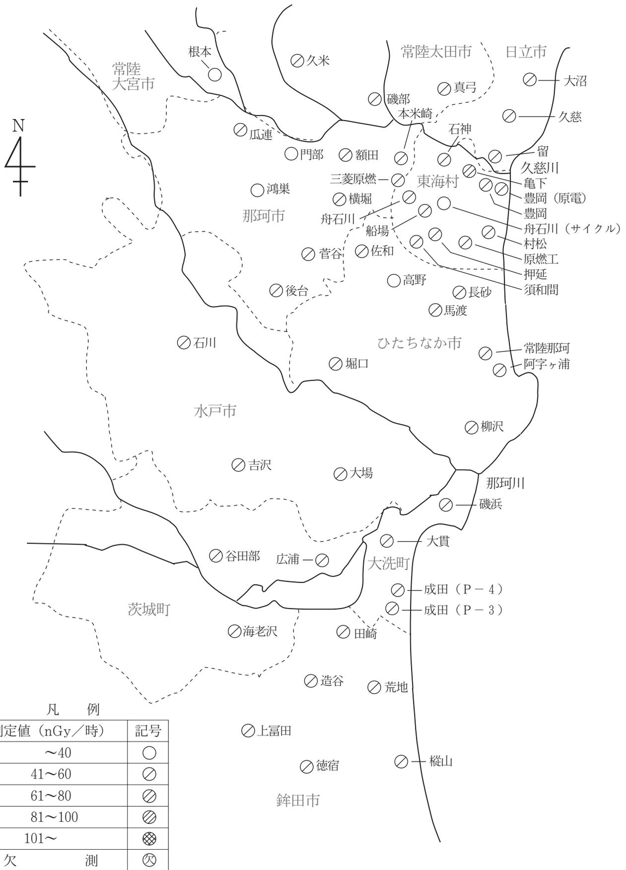
図1 原電又は原子力機構大洗から10km圏内の一般環境における空間γ線量率測定結果（3か月平均値）
