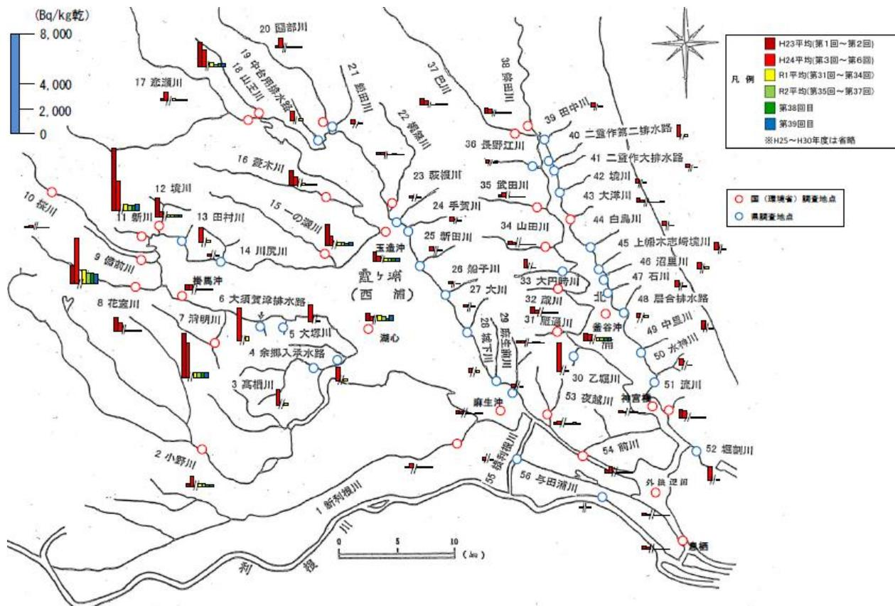
図 霞ヶ浦流入河川の底質の放射性物質モニタリング調査結果
