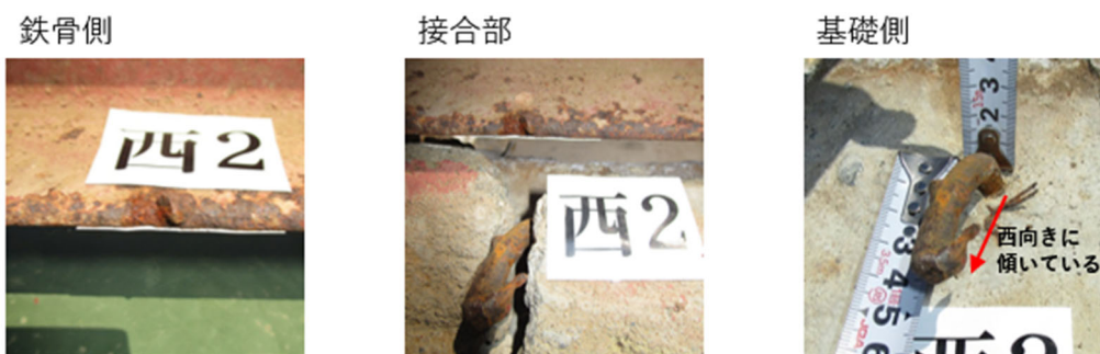
図 27 西 2 の写真 (“接合部”は、接合した状態を再現して撮影したもの)
