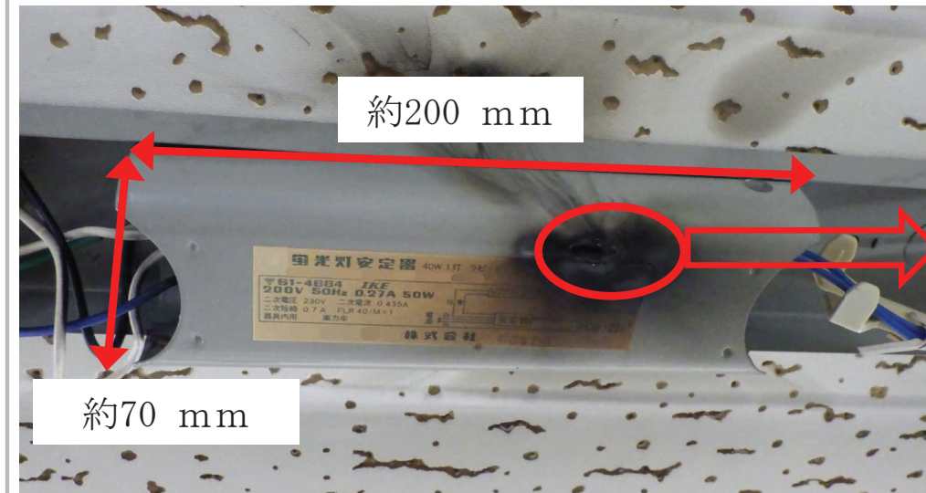
焼損した当該安定器 安定器の一部が焼損しており、約10 mm、約2 mmの開孔を確認
