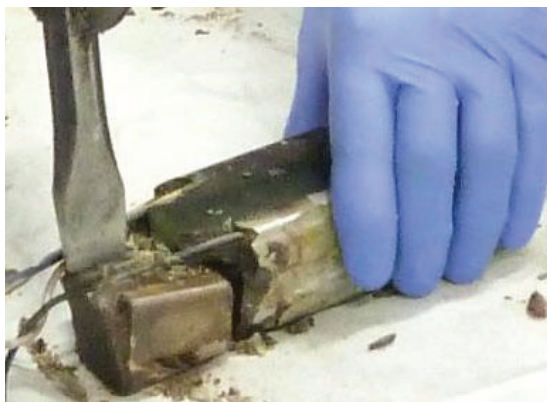
工具によりコンパウンド樹脂を剥離
