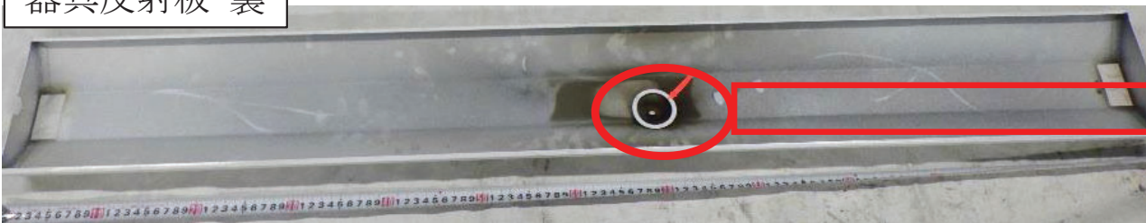
焼損した当該蛍光灯器具の器具反射板表裏の状況
