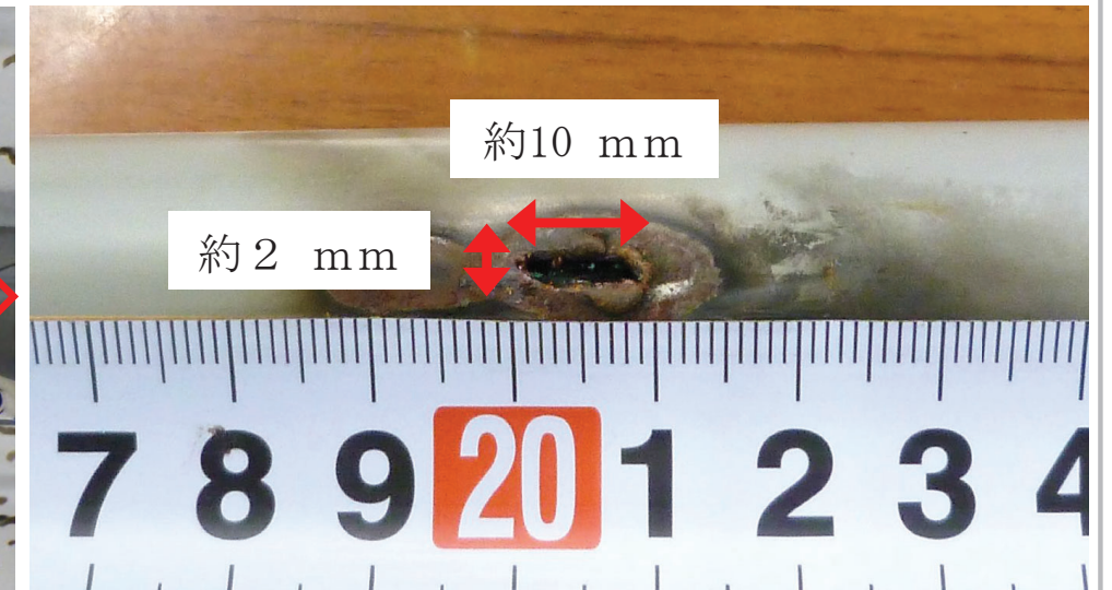
焼損した当該安定器 安定器の一部が焼損しており、約10 mm、約2 mmの開孔を確認
