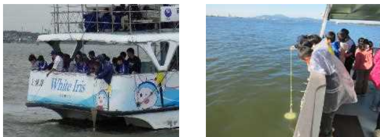
（左）船内からのプランクトン採集、（右）船内からの透明度測定
