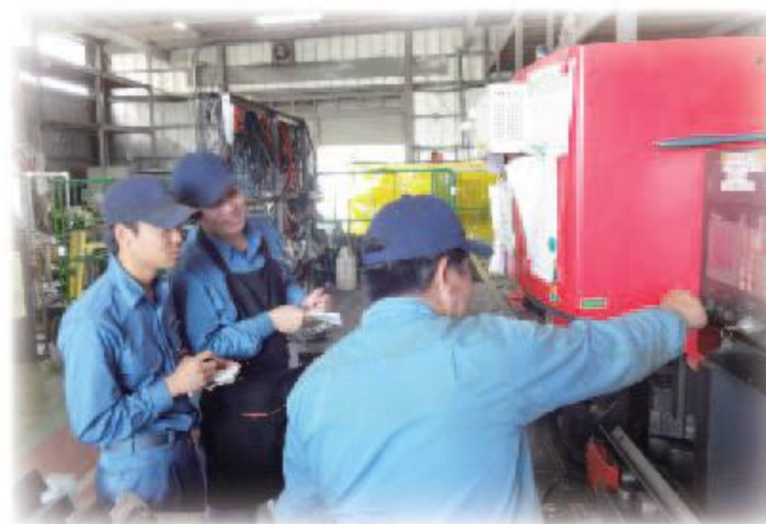
アイアンワーカーでのアングル切断作業
