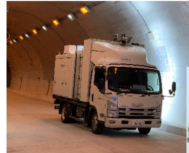
トンネル点検車による3D画像解析
